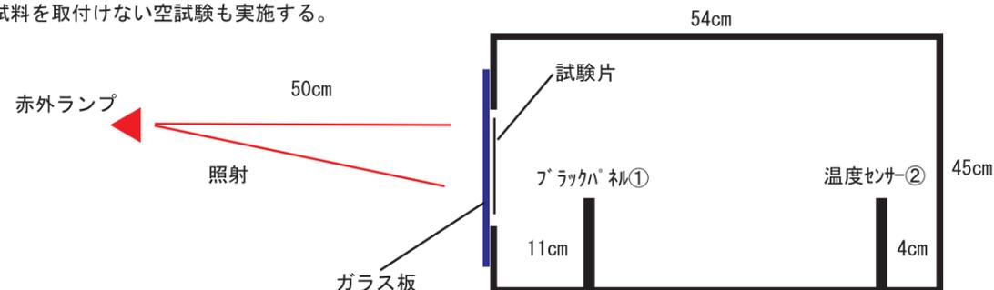
上昇温度差 (°C) = 空試験の最大上昇温度 - 試験片試験の最大上昇温度
