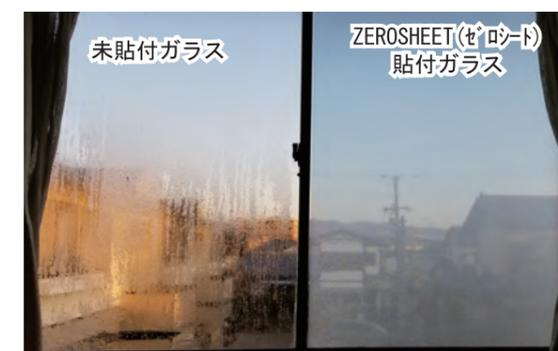
ZEROSHEET（ゼロシート）貼付ガラスは室内側の熱を吸収して室外に逃がしにくくします。その結果、未貼付ガラスよりもZEROSHEET（ゼロシート）貼付ガラスの方がガラス表面温度が高くなり、結露の発生量を軽減する効果が期待できます。
