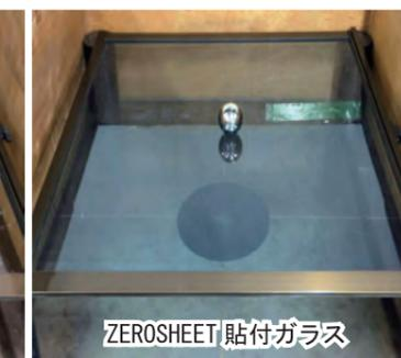
ZEROSHEET（ゼロシート）貼付ガラスは高さ180cmから落下（同じ場所へ連続9回）させてもガラスにひび割れ、破損が発生しなかった。
